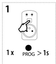
Press of programming button on receiver RFDSC-71 for 1 second will activate receiver RFDSC-71 into programming mode. LED is flashing in 1s interval. Drücken der Programmier Taste am Empfänger RFDSC-71 für 1 Sekunde aktiviert den Programmiermodus des Empfängers RFDSC-71 LED blinkt im 1s-Intervall.
