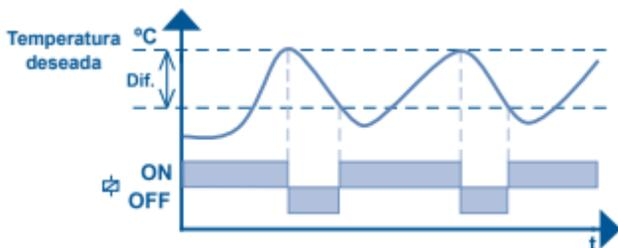
Funcionamiento en Control por Aproximación - El control de la temperatura se realiza en modo ON/OFF y en control PID. Se activa cuando la temperatura ambiente está alejada del diferencial definido. Cuando la temperatura se encuentra dentro del valor diferencial, el control se realiza por aproximación para evitar que supere la temperatura definida (control PID).
