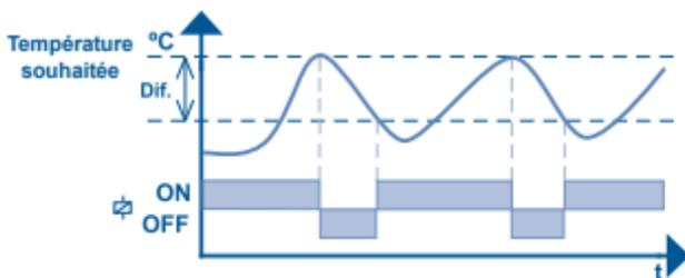
Fonctionnement sous le contrôle par approximation - Le contrôle de la température est fait en mode ON/OFF et en mode PID. Il s'allume lorsque la température ambiante s'éloigne plus que le différentiel défini. Lorsque la température se trouve dans les limites de la valeur différentielle, le contrôle se fait par approximation, en vue d'éviter que la valeur de température définie soit dépassée (contrôle PID). Le système s'éteint lorsque la température atteint la valeur définie.
