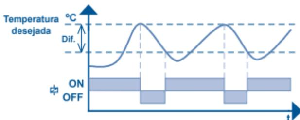
Funcionamento no Controlo por Aproximação - O controlo da temperatura é feito em modo ON/OFF e em controlo PID. Liga quando a temperatura ambiente está afastada mais do que o diferencial definido. Quando a temperatura se encontra dentro do valor diferencial o controlo é feito por feedback garantindo que se mantém dentro dos valores definidos (controlo PID).
