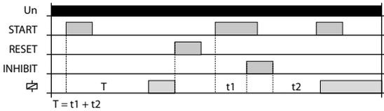
Nach der Zuführung der Versorgungsspannung wird das Relais geöffnet. Ist der Steuerkontakt START geschaltet, startet die Zeitverzögerung T. Nach dem Abschluss des Timings schaltet das Relais. Das Schalten des Steuerkontakts START im Verlauf des Timings bzw. Countdowns wird ignoriert.
